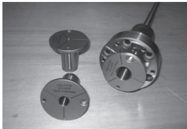
Hydro-Dehndorn-Flansch auf Spindel montiert!!!!
