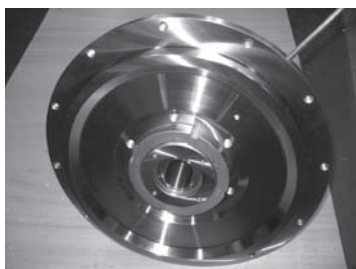
Zur Zentrierung von CBN-Schleifscheiben
