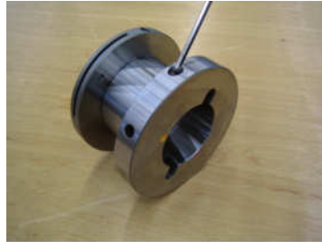
Hydro-Dehndorn-Flansch auf Spindel montiert!!!!
