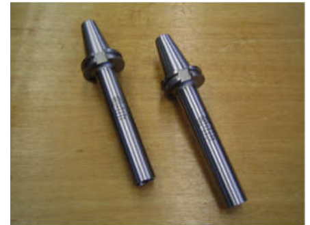
SK-40 x \varnothing 25 x \varnothing 32 x 190 Art.-Nr. 4004-608.00
