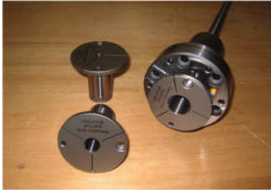
Hydro-Dehndorn-Flansch auf Spindel montiert!!!!
