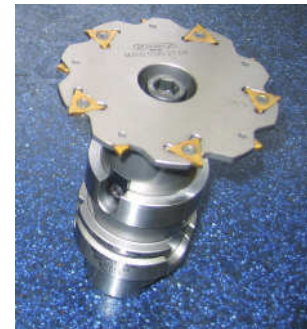
HSK-A63 x \varnothing 20 x 34 x 160 Art.-Nr. 4003-131.00
